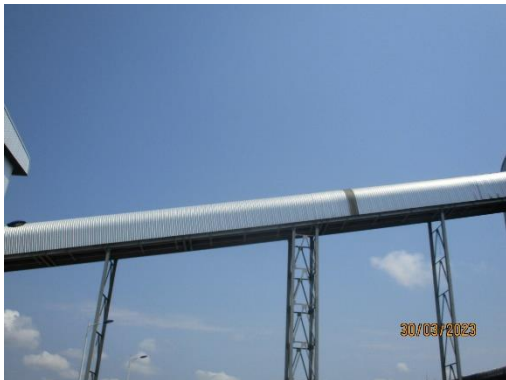
รูปที่ 21 ระบบสายพานลำเลียงแบบปิดครอบ
